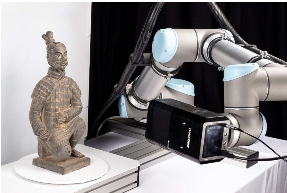
Bild: Der CultArm3D-P ist eine flexible Lösung für hochauflösende Scans kultureller Güter. (@ Fraunhofer IGD)
