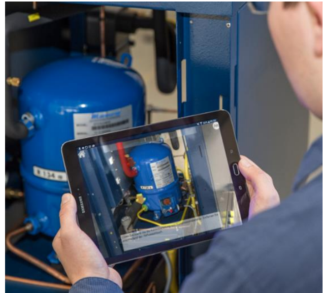
Abbildung 3: Einsatz der dreidimensionalen Arbeitsanweisungen auf einem Tablet zur Erklärung bzw. Anleitung von Montage- und Wartungsaufgaben.
