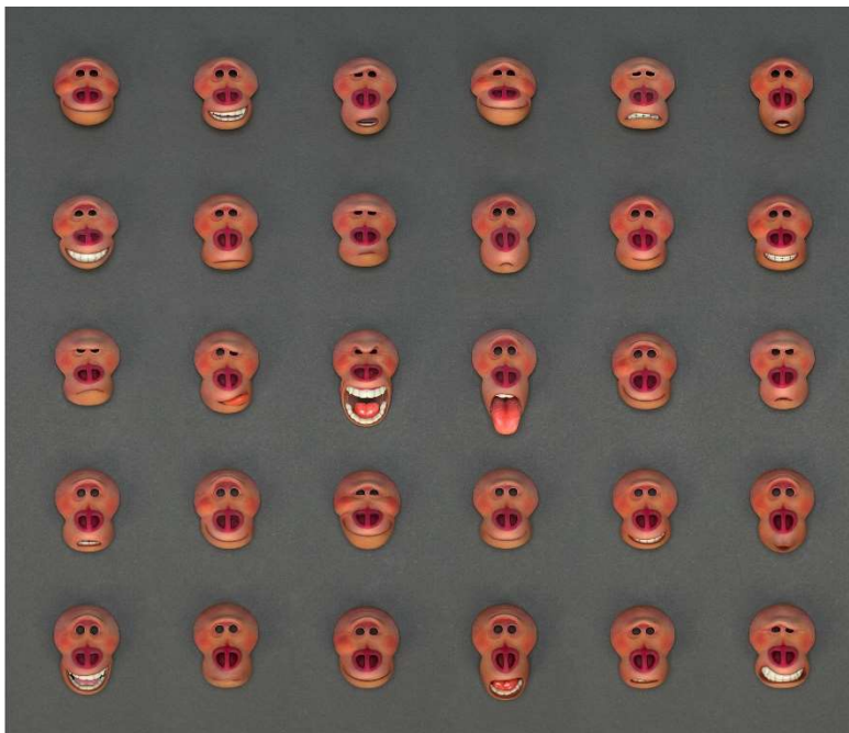
Bild 2: Mr. Links unterschiedliche Gesichtsausdrücke und Emotionen wurden auf einem 3D-Drucker mittels der patentierten Cuttlefish-Technologie des Fraunhofer IGD ausgedruckt. (© LAIKA)
