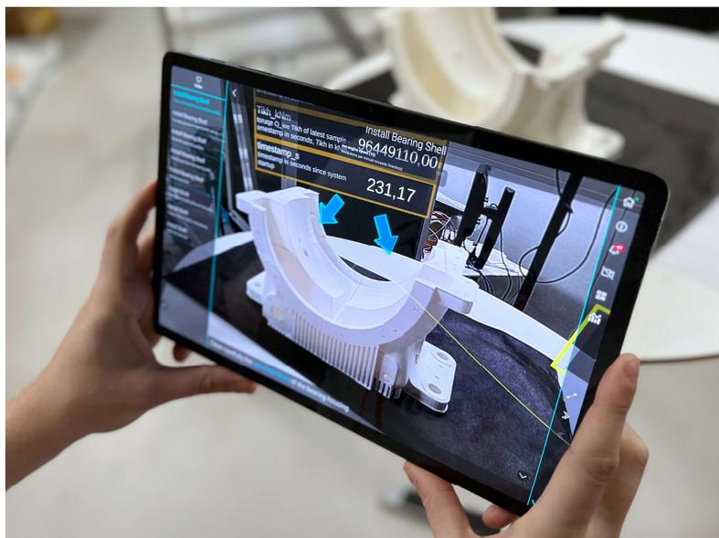
Bild: Wie lässt sich eine Lagerschale einbauen? Die maritime Serviceplattform versetzt die Schiffsbesatzung in die Lage, Wartungsarbeiten selbstständig im laufenden Betrieb durchzuführen. (Quelle: Fraunhofer IGD)
